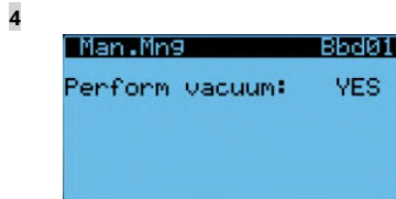
Sélectionner OUI - La soupape HPV et la soupape d'équilibrage s'ouvrent selon la configuration de la fenêtre Bbd02
